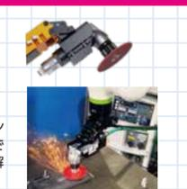
**ニューレジストン** 溶接ビード研削ロボットシステム
