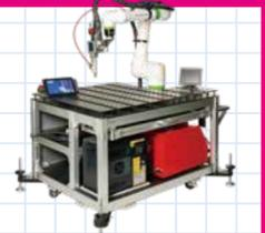
**大型構造物自動溶接システム** 大型ワーク教示レスアーク溶接システム
